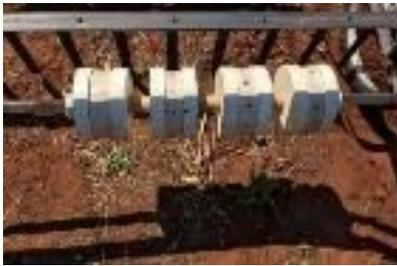
**Figura 2:** Diferentes distribuidores utilizados nos testes. Da esquerda para direita: Distribuidor 1 (8 furos de 2mm), Distribuidor 2 (16 furos de 2mm), Distribuidor 3 (16 furos de 5mm) e Distribuidor 4 (8 furos de 5mm).
