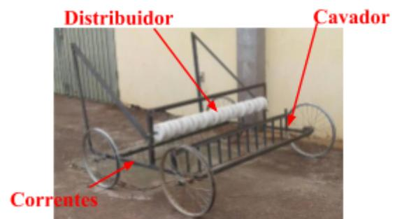
**Figura 1.** Como era realizado os testes da semeadeira no laboratório de usinagem.
